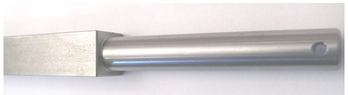
Achse verbessert, Achszapfen angedreht
